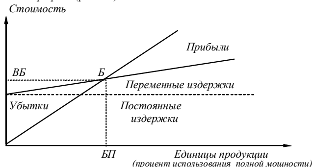
Рис. 9.3. График определения точки безубыточности ВБ - величина безубыточности; БП - безубыточное производство; Б - точка безубыточности (все величины издержек и продаж - годовые)
